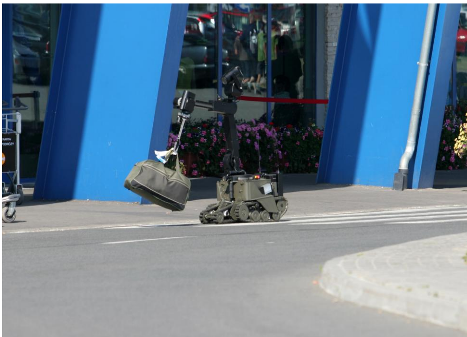
Fotografia 1: Robot do unieszkodliwiania ładunków wybuchowych w trakcie pracy przed terminalem.
