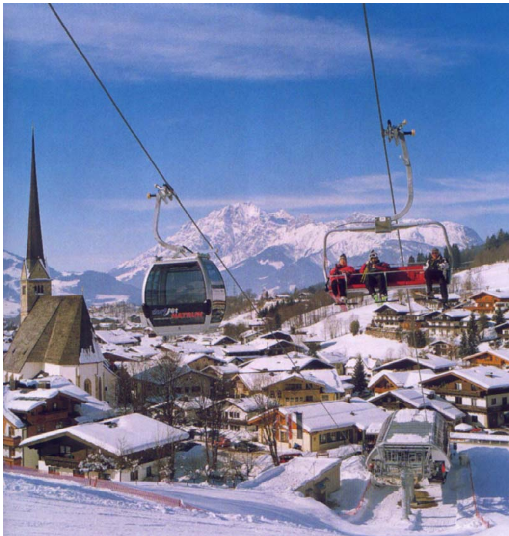
Kolej gondolowo-krzesiolkowa, Salzburg Austria (2002 r) Długość 1074 m, prędkość jazdy 4.5 m/s, zdolność przewozowa 1246 os./godz.
